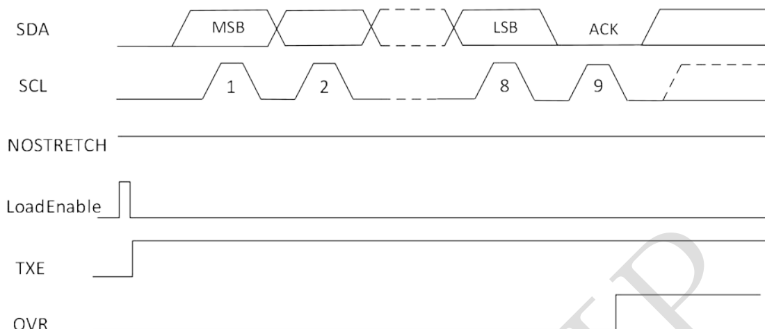
图 22-5 从机发送模式时钟延长时序（虚线部分 SCL 为低，主机无法发送 SCL）
